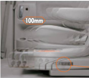
シート左側のスイッチ操作で電動でスライドします。
