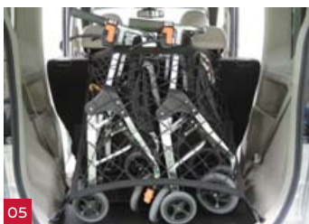
05 車いす/歩行器固定用ゴムネット 折りたたんだ車いす/歩行器をゴムネットで簡単に固定できます。 ※収納可能な車いす/歩行器の目安等、詳細はP3をご覧ください。
