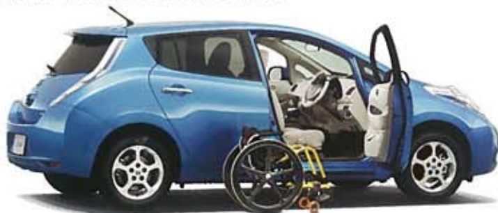
Photo: ドライビングヘルパー G、オプション装着車。ボディカラーはアクアブルー(3PM) (#RAT-特別塗装色)、内装色はエアリーブルー(K)。車庫回転のシートスライド機能が利用されます。(スライド量:最後尾から前方に108mmまで) http://lv.nissan.co.jp/LVCAR/LEAF/DRIVEGE_E/
