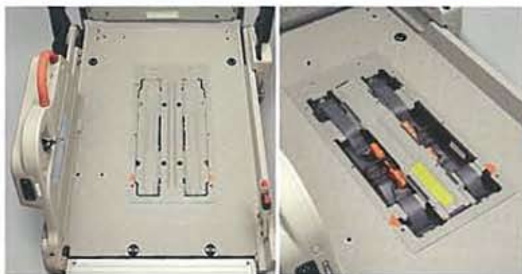
車いすが固定装置の中央になる位置に乗せ、ブレーキをかけ、カバーを開けます。(固定位置の目安) 車いすの後輪の接地面をオレンジの三角マーキングに合わせます。
