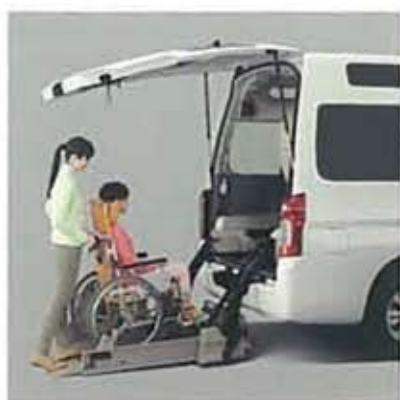
車いすをリフターのプラットフォームに乗せ、ブレーキをかけ、車いすを固定装置で固定します。
