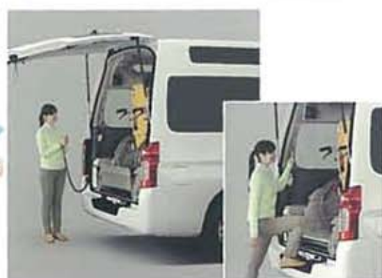
リフターは、全自動で車内に格納されます。フラッパーを前に倒すことができるので、バックドアからの乗降が容易です。
