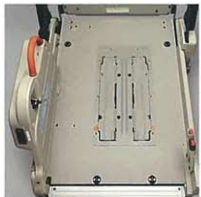
車いすが固定装置の中央になる位置に乗せ、ブレーキをかけ、カバーを開けます。(固定位置の目安)
