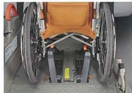
スイッチを1回押すだけでしっかりと固定できます。特殊な形状の車いすを固定する場合には、オーテック扱いディーラーオプションの「特殊車いす固定ベルト」(P9)をあわせてお選びください。
