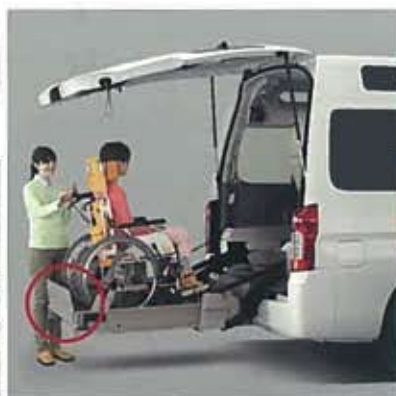
リモコンの「入」ボタンを押すとフラッパーが自動的に起き上がり、リフターが上昇を開始します。
