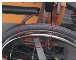
シートベルトはスポークの間を通して装着します。
