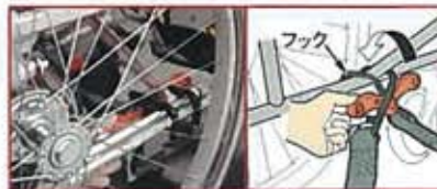
車いすを固定金具を取り出し、オレンジ色の取手部分を持ちます。右図のように車いすのフレームが交差する部分左右2カ所に掛けます。車いすの前後にフックをかける必要はありません。
