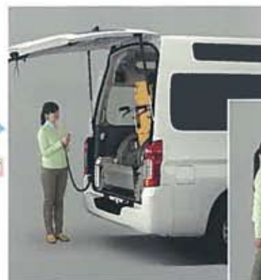
リフターは、全自動で車内に格納されます。フラッパーを前に倒すことができるので、バックドアからの乗降が容易です。
